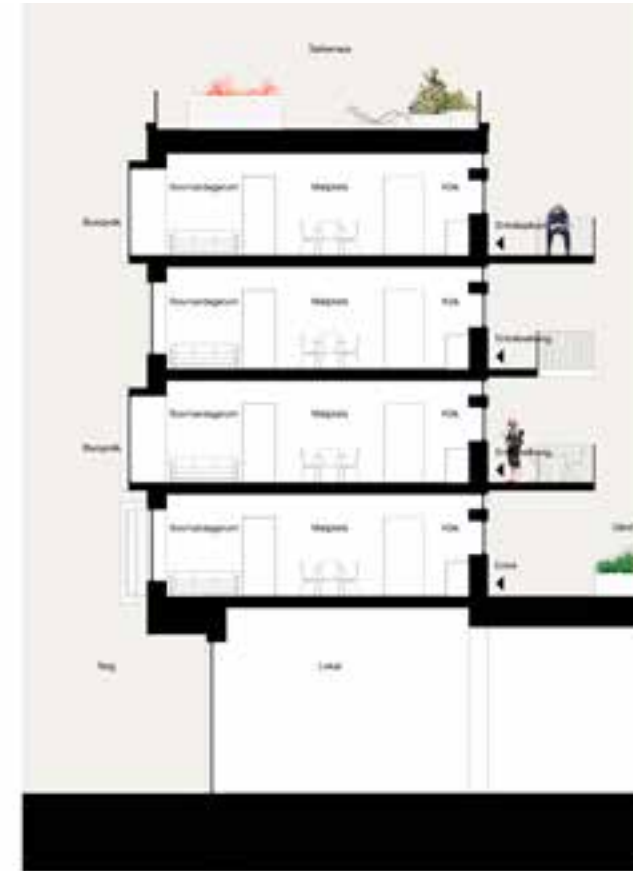
Sektion Burspråk skapar en tredimensinell fasaduttryck mot torget.
