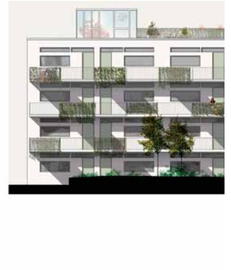
Fasadutsnitt Gårdsrummets fasad har entrébalkonger med utanpåliggande upphållszoner. Balkongerna är begrönade med slingplanter på vertikala stålvaror.
