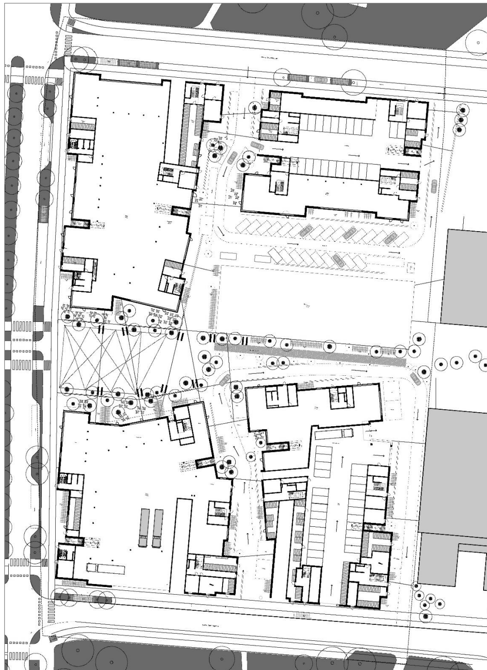
Figur: Översikt med cykel- och bilparkering i markplan och garage (handikapparkering är markerad som att 6*5 m ska vara hinderfritt i markplan).
