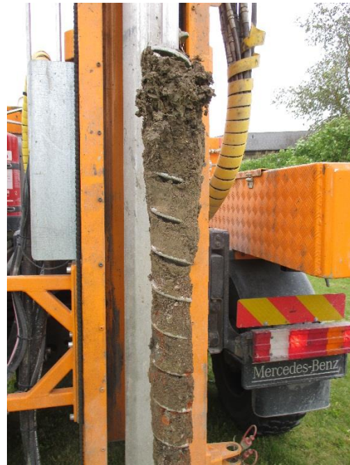
Bild 3D: 14BM09, 0-1 m Översta 4 dm är lerig fyllning med mylla. Därunder följer sandig, lerig fyllning med tegelinslag.
