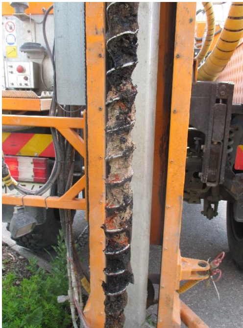
Bild 3C: 14BM07, 1-2 m Provtagning av sandig, lerig fyllning 1,0-2,0 m. Mörkare leriga partier varvat med ljusare sand med inslag av tegel.
