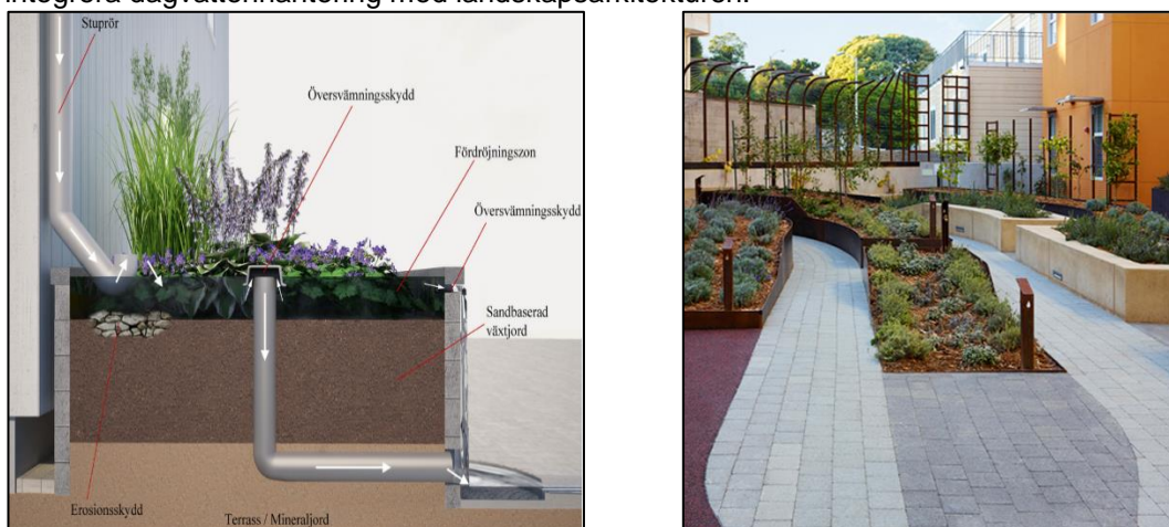
Figur 6. Tv: Tvärsnitt av en växtbäddarna i anslutning till byggnad. Th: Illustration över växtbäddar i ett bostadsområde i anslutning till gårdsmark.
