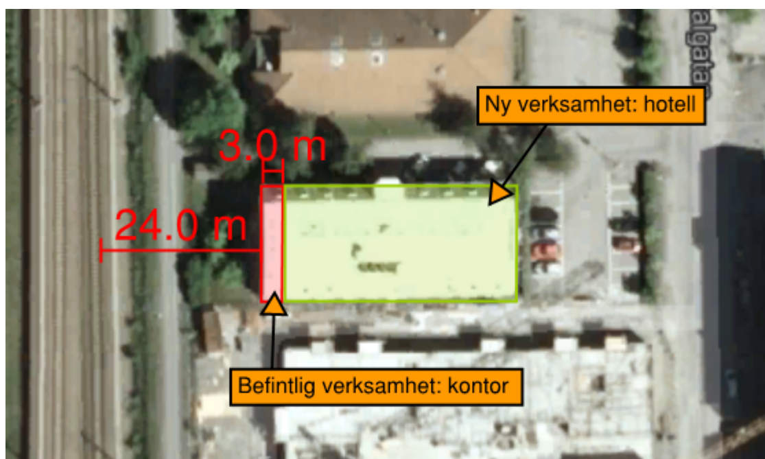
Figur 13. Om riskreducerande åtgärder vidtas är det ur risksynpunkt acceptabelt att placera hotellverksamhet minst 27 meter från järnvägen (d.v.s 3 meter in i aktuell byggnad).
