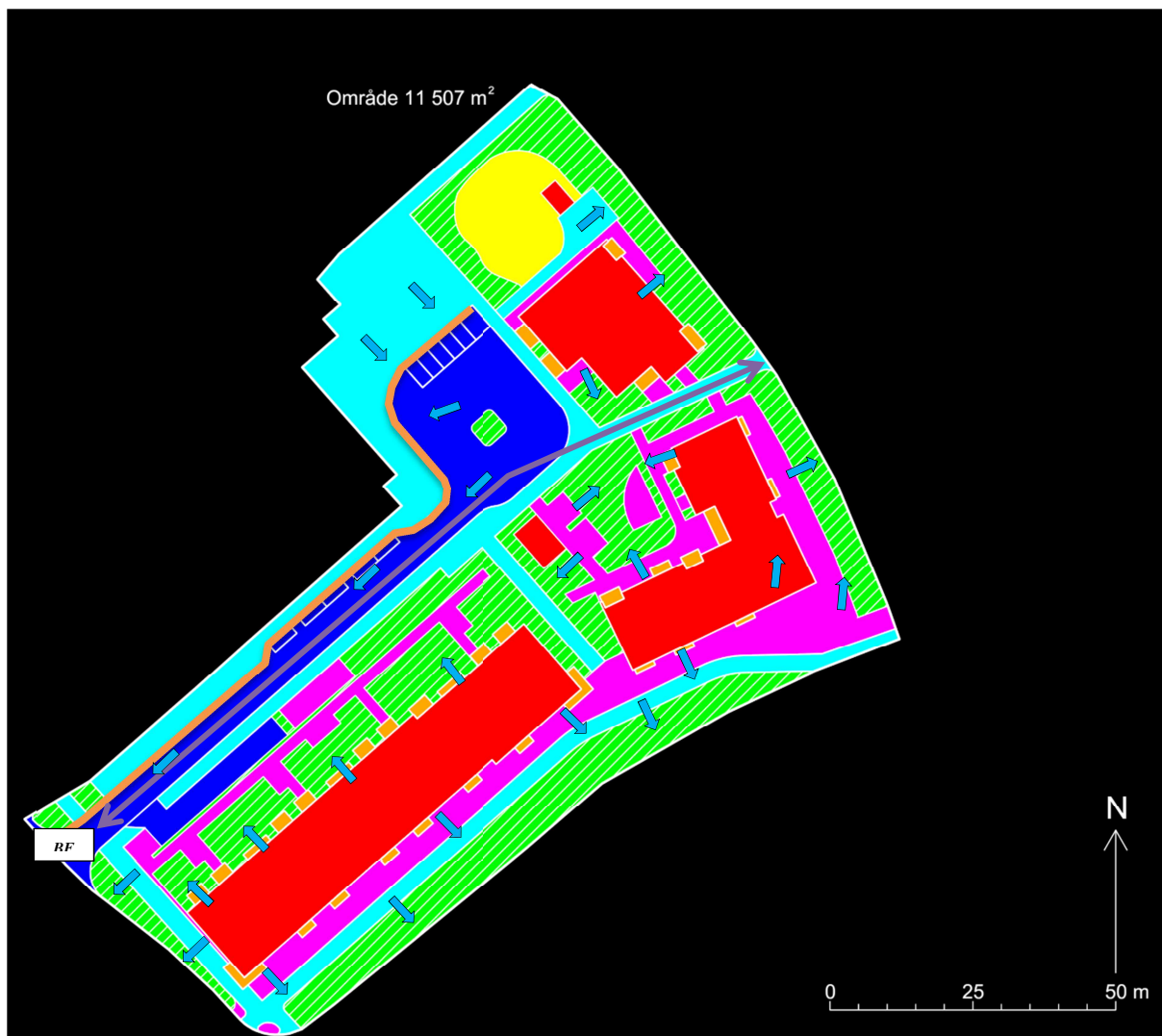
Figur 5-1. Principskiss på ungefärliga placeringar av dagvattenlösningssystem. Områden som kan anläggas med skelettjord är snedstreckade i grönt, rektangel med BF = Brunnsfilter, förslag på flödesriktningar är markerade med blå pilar, alternativ flödesväg med lila pil och ränna för infiltration till makadammagasin under gångbana är markerad med orange linje.
