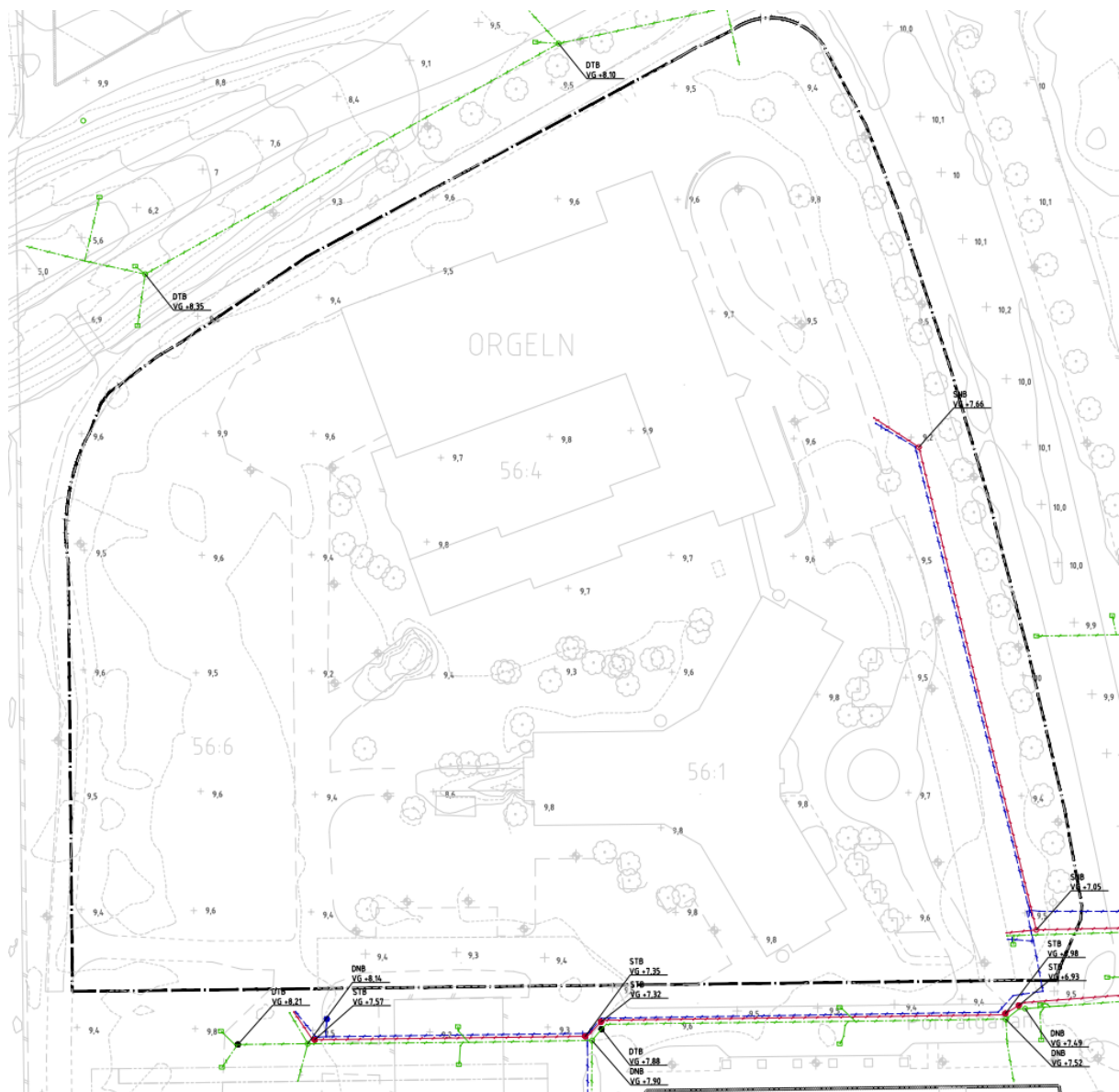
Figur 5: Befintligt VA-system samt arbetsområdesgräns.
