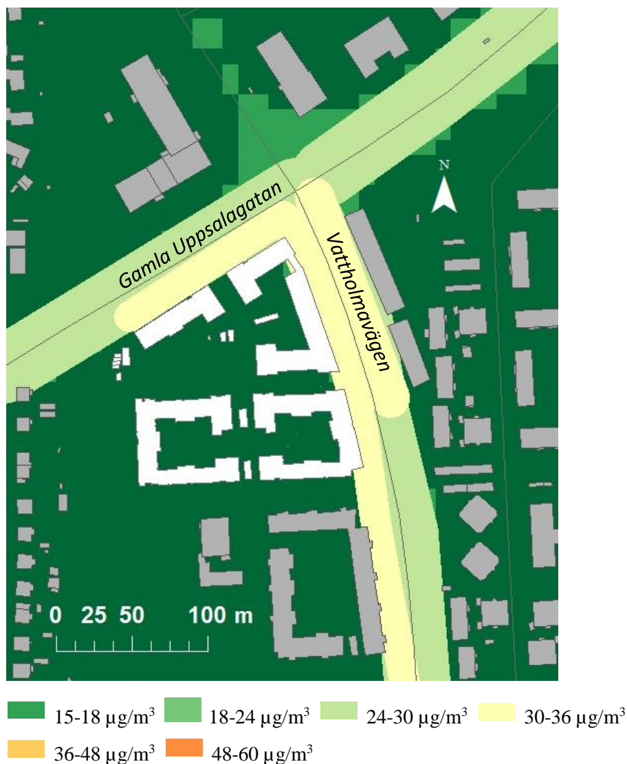
Figur 3. Beräknad dygnsmedelhalt av kvävedioxid, NO 2 (µg/m 3 ) under det 8:e värsta dygnet år 2030 med ny bebyggelse kv. Kvarngärdet markerad i vitt. Normvärdet som ska klaras är 60 µg/m 3 .
