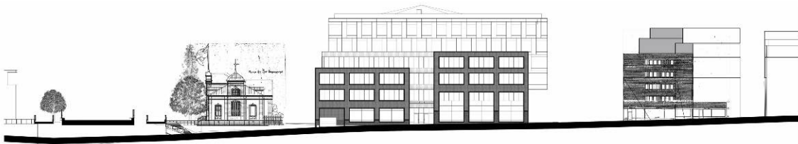
S:t Persgatans fasader mot nordväst, med det underliggande förslaget. Illustrationen visar hur den nya byggnaden förhåller sig till omkringliggande bebyggelse genom en nedtrappning av volymer. Illustration: Sweco.
