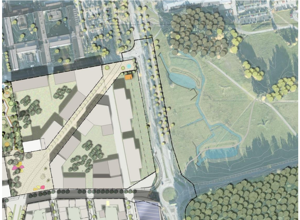
Figur 13. Födröjningsdamm Polacksbacken. Exempelskiss för att visa hur födröjning skulle kunna förläggas.
