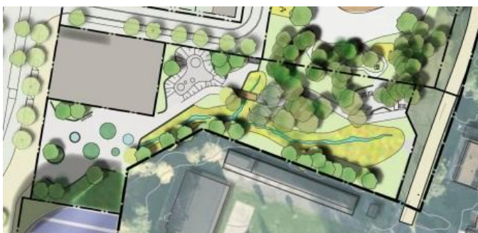
Figur 51; Förslag till dagvattenhantering norr om brandstationen.
