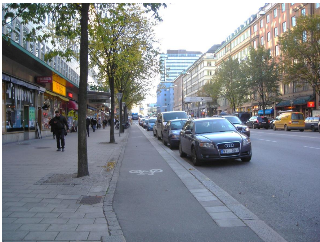
Bild 6 Platttrad mellan (enkelriktad) cykelbana och uppställda bilar. Gångbanan och cykelbanan på bilden är totalt cirka 8,5 meter inklusive skyddsremsa mot de parkerade bilarna.
