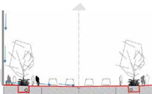
Principsektion för täta skikt (röd linje) i gata. Illustration Sweco.
