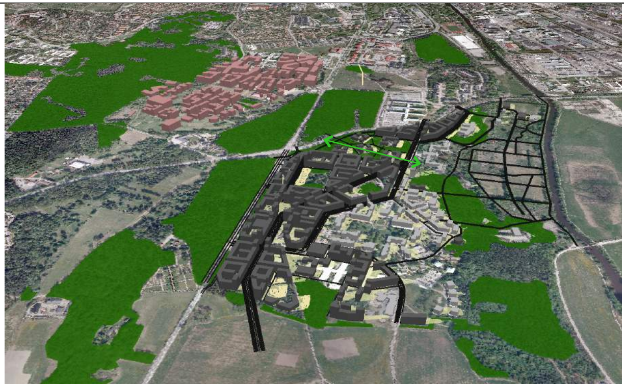
Figur 14. Scenario justerat program. 3D visualisering. Nya byggnader visas i mörkgrått och befintliga sparade byggnader i ljusgrått. Gula zoner visar skuggor kl 16 i april. Gröna ytor är livsmiljöområden med gammal tallskog. Den ljusgröna pilen visar läget för grönytan Tallstråket som är tänkt att ha funktion som spridningssamband.
