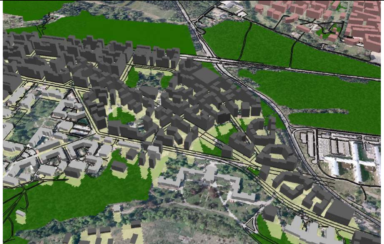
Figur 15. Scenario programsamråd, detalj. 3D visualisering. I förgrunden syns tallskog på åsen. Den ansluter till grönytan Tallstråket. Nya byggnader visas i mörkgrått och befintliga som blir kvar i ljusgrått. Gula zoner visar skuggor kl 16 i april. Tallstråket är 30 – 80 m brett och stora delar beskuggas på eftermiddagen.
