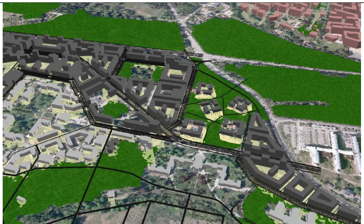
Figur 16. Scenario justerat program, detalj. 3D visualisering. I förgrunden syns tallskog på åsen. Den ansluter till grönytan Tallstråket. Nya byggnader visas i mörkgrått och befintliga som blir kvar i ljusgrått. Gula zoner visar skuggor kl 16 i april. Tallstråket är ca 200 m brett med 5 kvarter med låga hus. Delar beskuggas på eftermiddagen.
