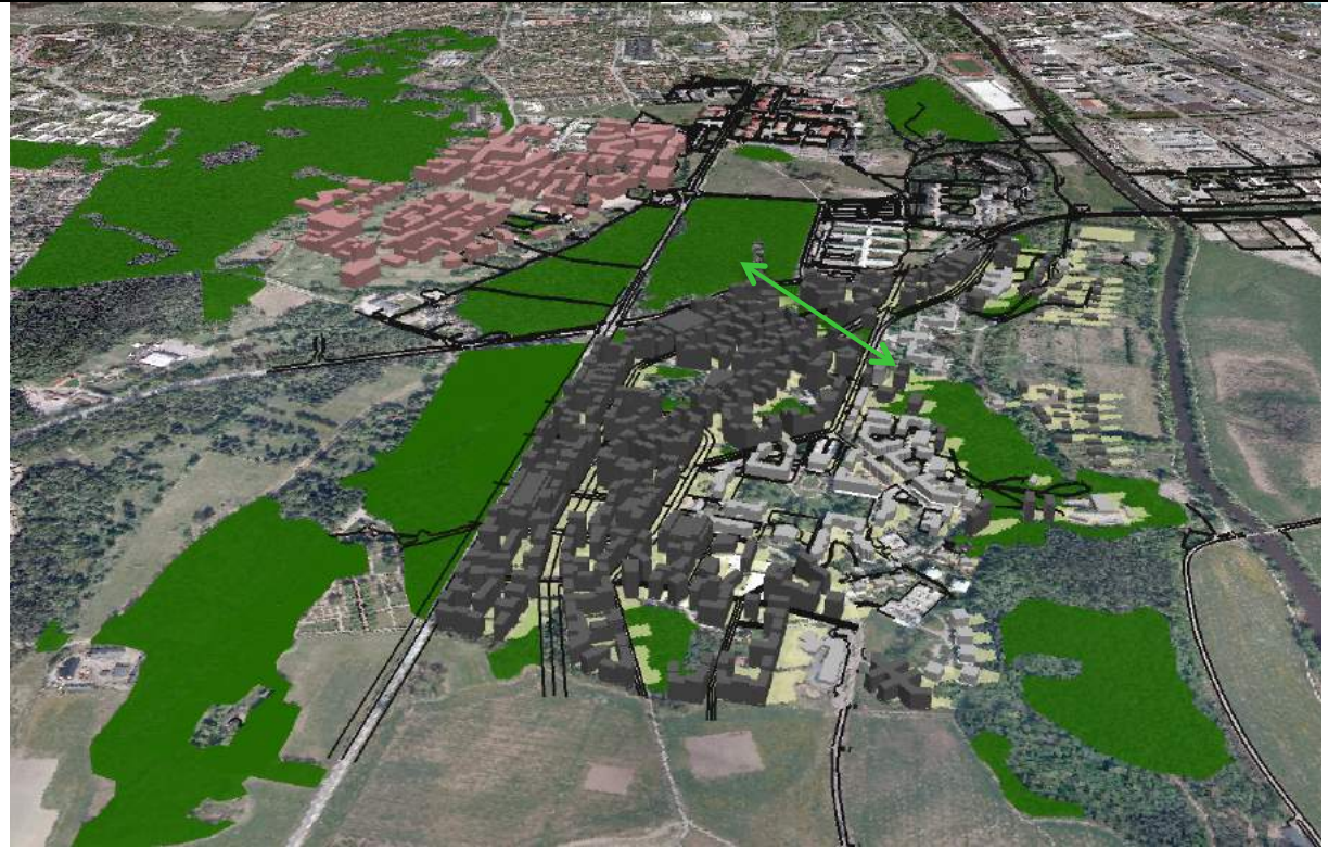
Figur 13. Scenario programsamråd. 3D visualisering. Nya byggnader visas i mörkgrått och befintliga sparade. Gula zoner visar skuggor kl 16 i april. Gröna ytor är livsmiljöområden med gammal tallskog. Den ljusgröna pilen visar läget för grönytan Tallstråket som är tänkt att ha funktion som spridningssamband.
