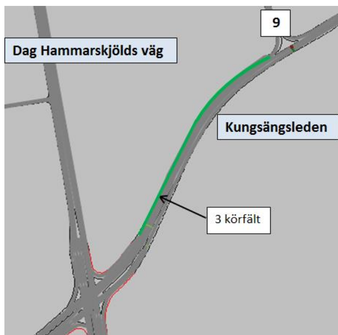
Figur 23. Ytterligare ett körfält på Kungsängsleden i västlig riktning
