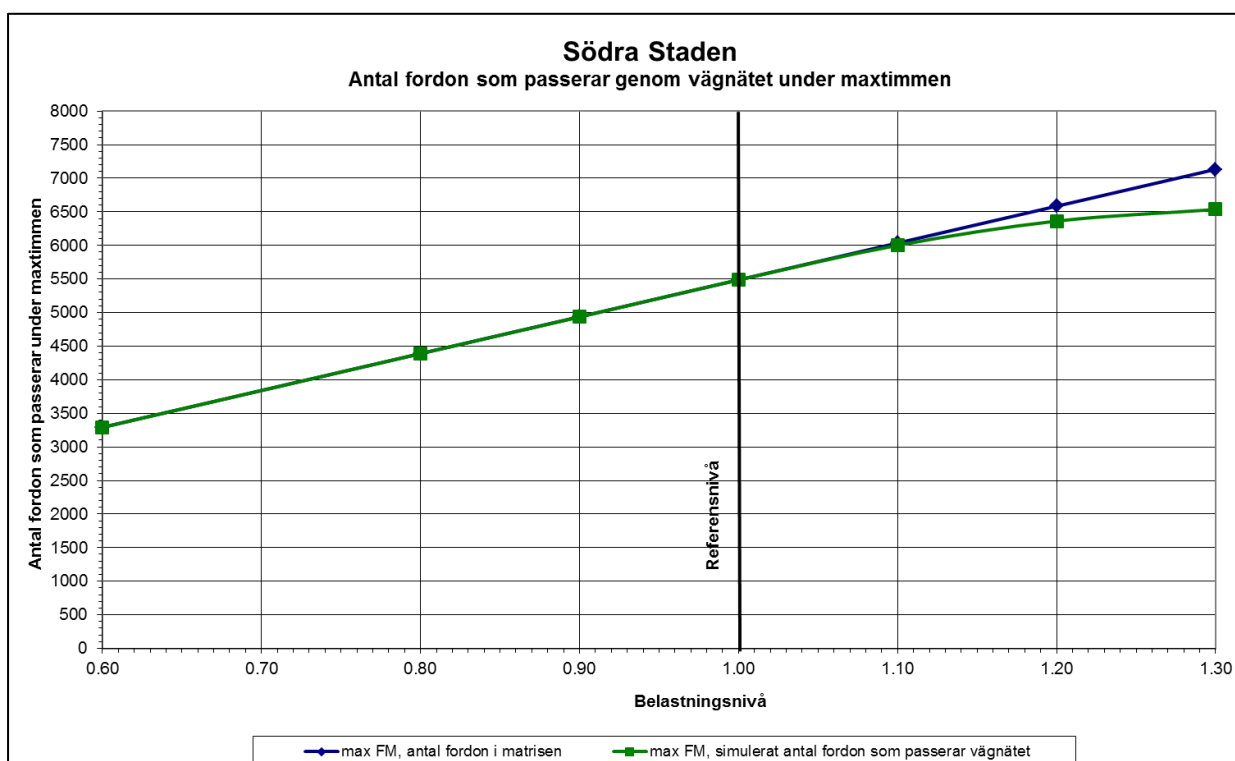
Figur 24. Antalet fordon som passerar under maxtimmen, i simulerat antal fordon i modellen med åtgärdsförslag, jämfört med antal fordon i matrisen. 0,6 utgör 60 % av trafikflödet för år 2050
