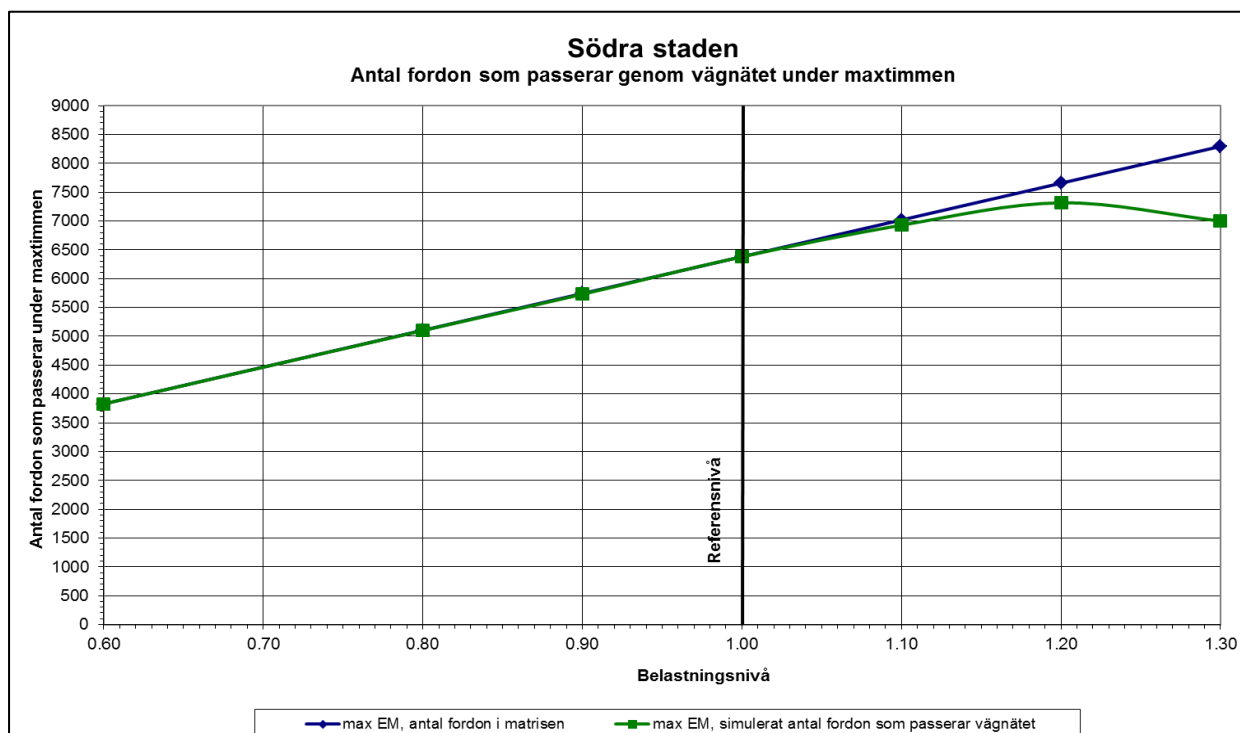
Figur 25. Antalet fordon som passerar under maxtimmen, i simulerat antal fordon i modellen med åtgärdsförslag, jämfört med antal fordon i matrisen
