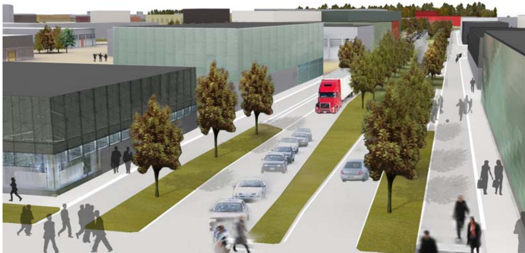
Perspektiv över Söderhällbygatan (vägsektion B) och dess uppbyggnad med körfält, trädreder och gång- och cykelstråk. Illustration: Werket
