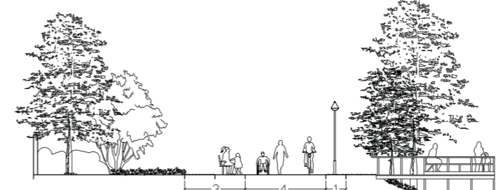
11 b. Vy: Cykelstråk breddas till 4 m. Kanter klipps som gräs. Sly och utskjutande grenar, samt döda träd och riskträd tas bort längs östra sidan (mot industritomt). 15. Tillgängligt trädäck i nivå med gc-väg anläggs i strandkant.
