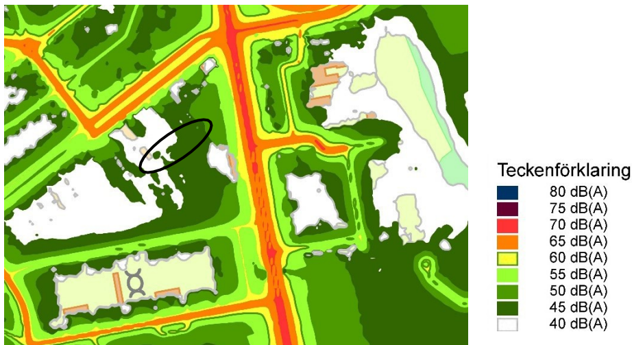
Utdrag ur bullerberäkning för vägar (Ramböll 2011). L max 2 m över mark. Ljudnivå i dB(A). Planområdets läge markerat med svart ring
