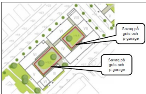
Förslag på fördröjning av dagvatten på gårdarna med hjälp av magasin. (Bjerking)
