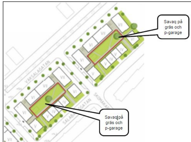
Förslag på fördröjning av dagvatten på gårdarna med hjälp av magasin. (Bjerking)
