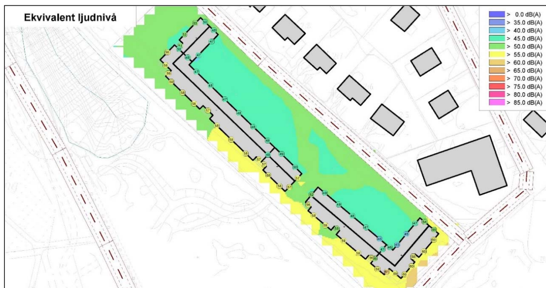
Bild 16: Ekvivalent ljudnivå vid mest utsatt del av fasad (i höjddled) samt 1,5 meter över mark. Bullerutredning från ACAD.
