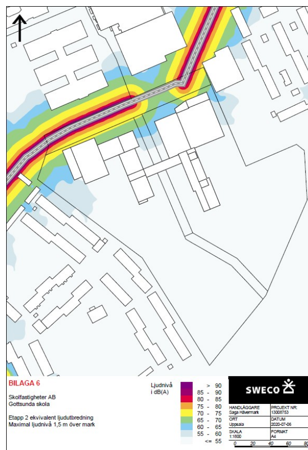
Figur 31 Utdrag ur trafikbullerutredning. Maximal ljudutbredning och ljudnivå 1,5 meter över mark. (Sweco)
