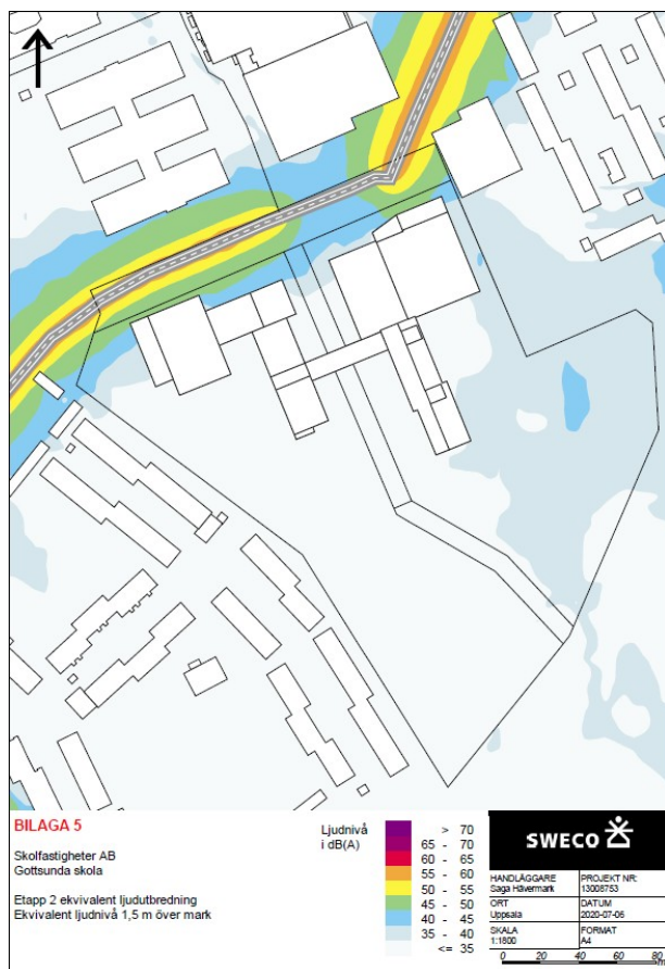
Figur 32 Utdrag ur trafikbullerutredning. Ekvivalent ljudutbredning och ljudnivå 1,5 meter över mark. (Sweco)
