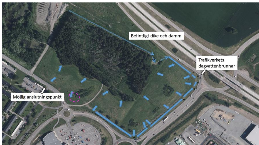
Figur 7. Principiell beskrivning av den befintliga avrinningen från området. Rosa markering utgör ungefärlig placering av drivmedelsstationen. Foto: hitta.se.
