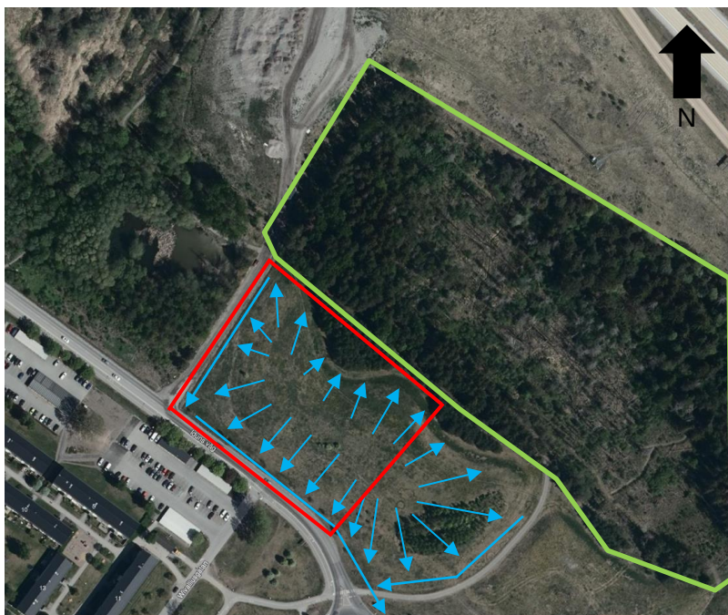
Figur 3: Karta över Befintliga förhållanden för Brillinge. Det aktuella området ramas in med röda linjer. Blåa pilar är rinnpilar och visar åt vilket håll vattnet rinner. Sumpskogen dit dagvattnet ska brädda vid extrema regn ringas in med gröna linjer. Karta från Hitta.se.
