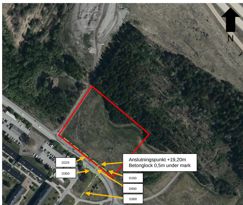
Figur 5: Illustrerar dagvattennätet i området och föreslagna anslutning för dagvattnet. Befintliga dagvattenledningar presenteras som streckade gröna linjer och området ringas in med röda linjer. Dimensioner enligt underlag från Uppsala Vatten 20161026-0496 presenteras i millimeter.
