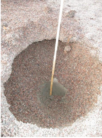
Bild 4C: Fallgrus 1A, norra sidan. Provgrop 0-0,55 m. Enstaka tegel i underliggande lera.
