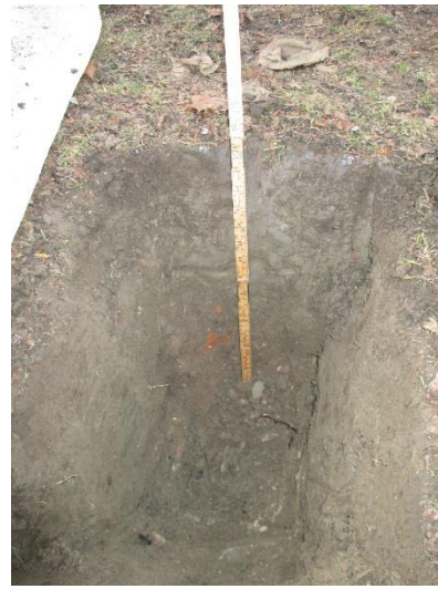
Bild 4D: Matjord A. Provgrop 0-0,4 m. Mull översta 0,1 m, underliggande lera innehåller tegel, glas och sten.
