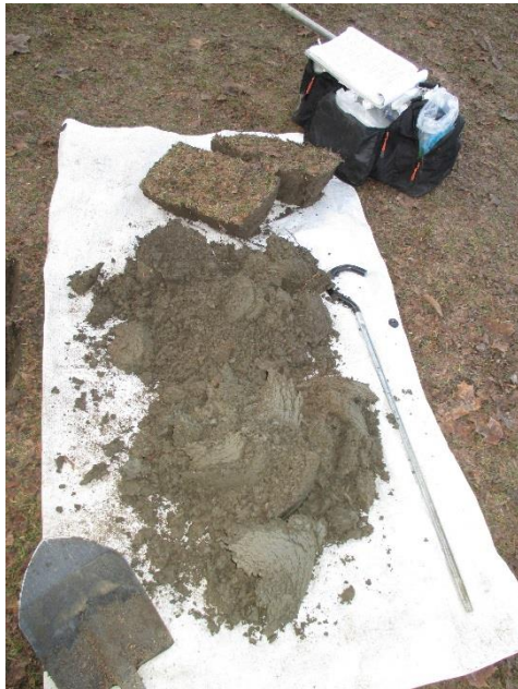
Bild 4A: Gräsyta 1 C, provgrop 0-0,5 m. Jordlagren upplagda uppifrån och ner i bild. På bilden syns även en geokäpp.
