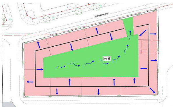
Förslag av princip för dagvattenhantering inom ett typkvarter med ny bebyggelse. Illustration: Bjerking
