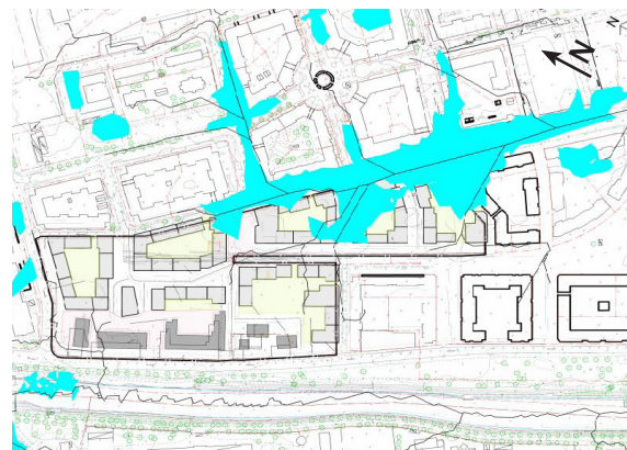
I bilden ovan redovisas Uppsala Vattens lågpunktskartering (blått) i kombination med strukturplan (daterad 2017-11-21). Karteringen indikerar en risk för instängt vatten längs bl.a. Sågargatan.
