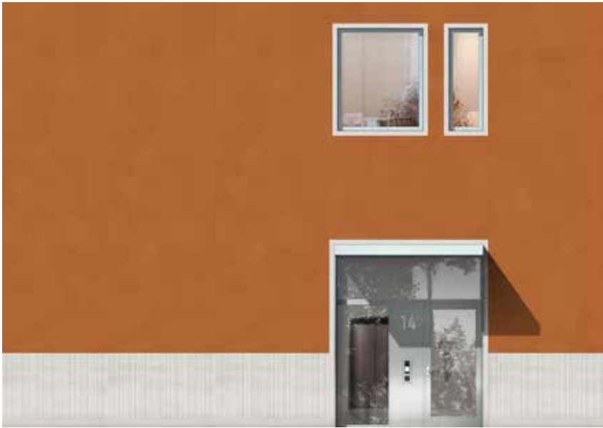
Putsad fasad med sockel i betong i en ljusgrå kulör
