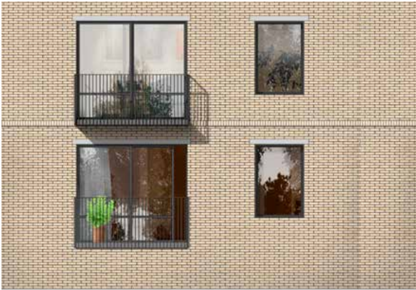
Tegel, markerad sockelvåning genom två rader utskjutande tegelsten (A)
