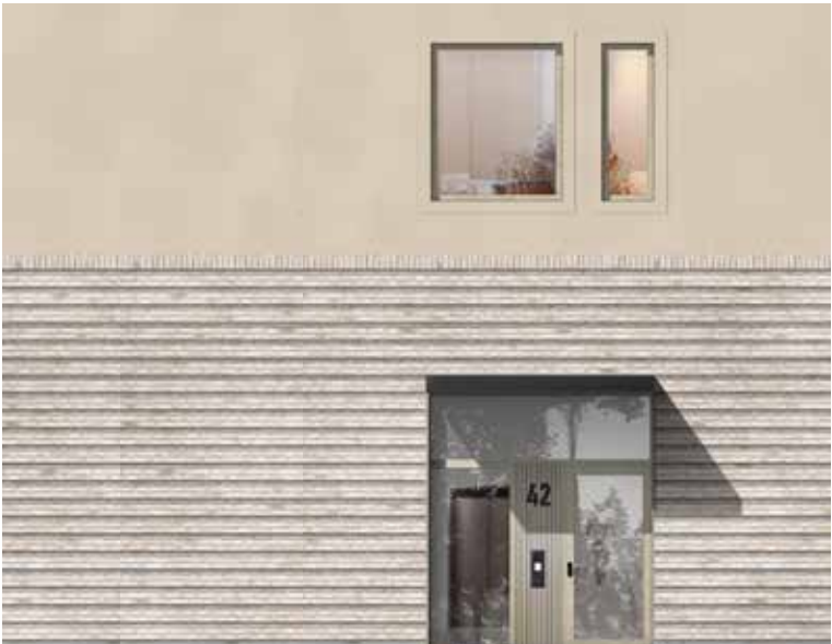
Betong, tegelsockelvåning i en mörkare nyas än fasadmaterialet (B)
