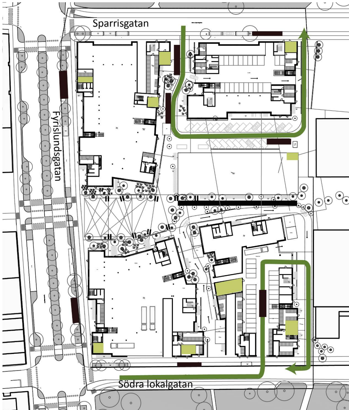
Figur: Lastplatser för avfall och varuleveranser (svart), avfallsrum (grönt) och körspår. Illustration: Juul Frost Arkitekter
