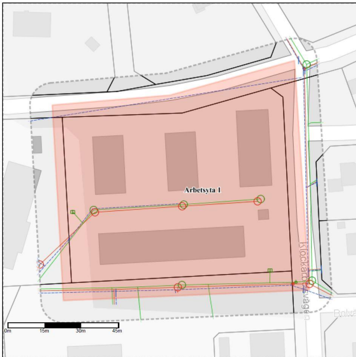
Figur 3-6. Gamla eller befintliga dagvattenledningar på planområdet fastighet 1:51 Bälinge.
