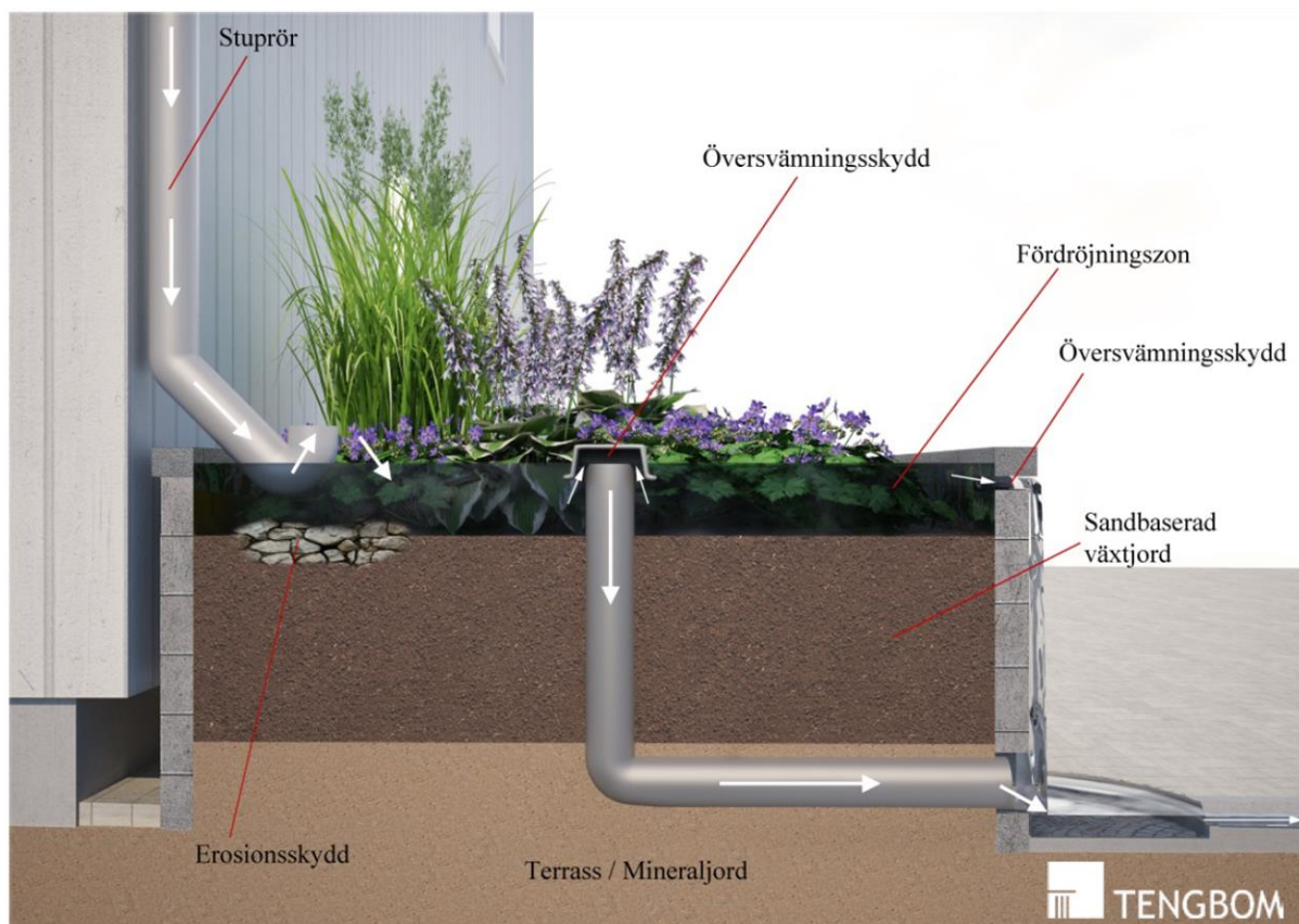
Figur 6-4. Växtbädd/regnbädd placerad intill byggnad vid utkastare från stuprör. Illustration av Kent Fridell 2014.
