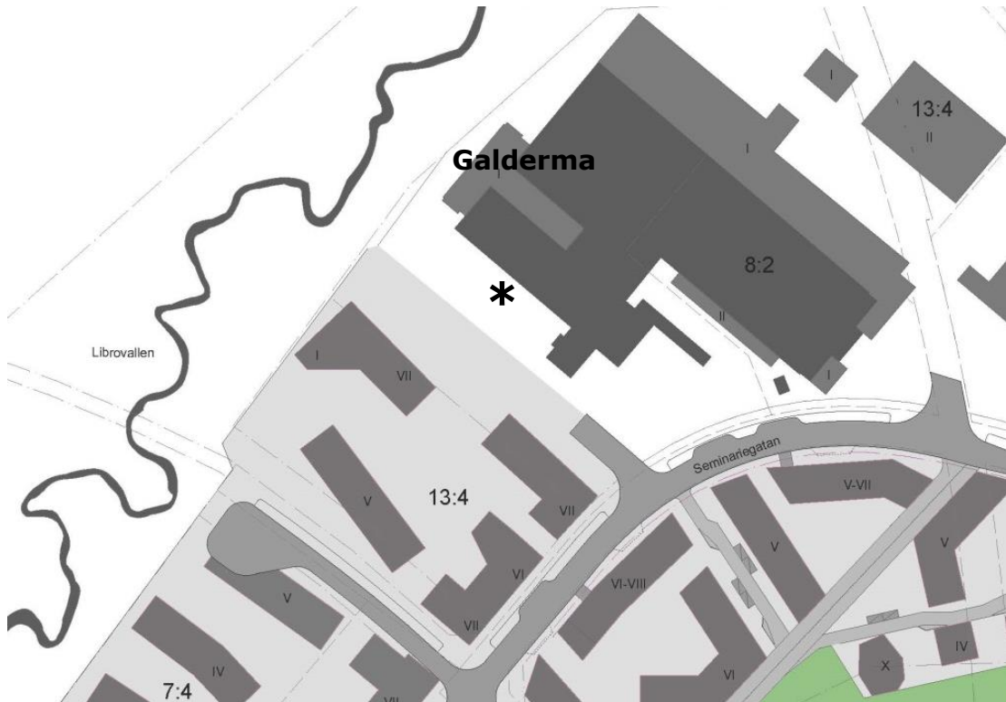
Figur 8 Tanken för etanolavfall markerad med *. Avståndet från tanken till byggnader på fastigheten Librobäck 13:4 är ca 35 m och avstånd till bostadshus på motsatta sidan Seminariegatan är ca 60 m.
