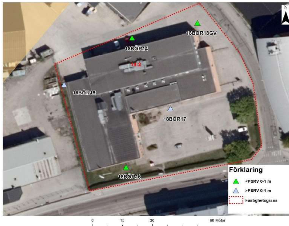
Figur 5. Föroreningsituation på fastighet Librobäck 14:2, i förhållande till PSRV. Blå färg indikerar att föroreningshalter överstiger PSRV 0–1 m, grön färg indikerar att de understiger PSRV 0-1 m.
