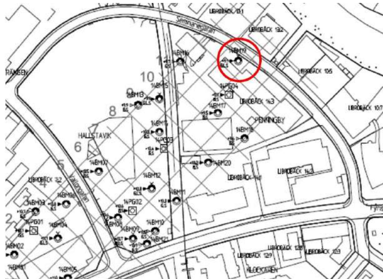
Figur 3. Utdrag av provtagningsplan för miljöteknisk markundersökning i Librobäck(deponin). (Bjerking, 2015). Provpunkt 14BM19 är markerad med röd ring.
