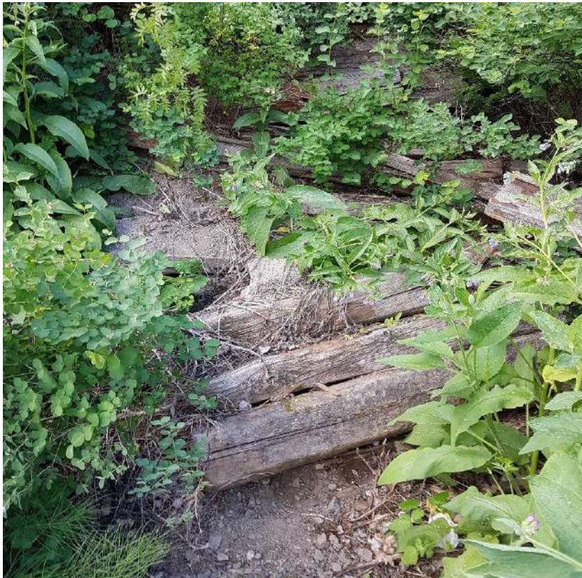
Figur 4. Hög med slipermaterial. Jord under dessa slipers provtogs samt ett materialprov av träet.
