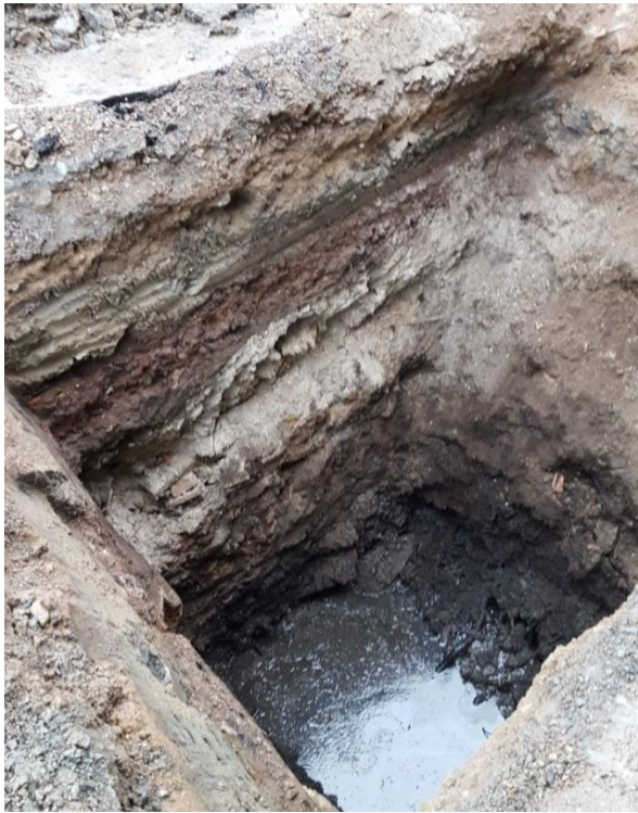
Figur 12. Exempel på lagerföljd av deponimaterial i provpunkt LIB1507.
