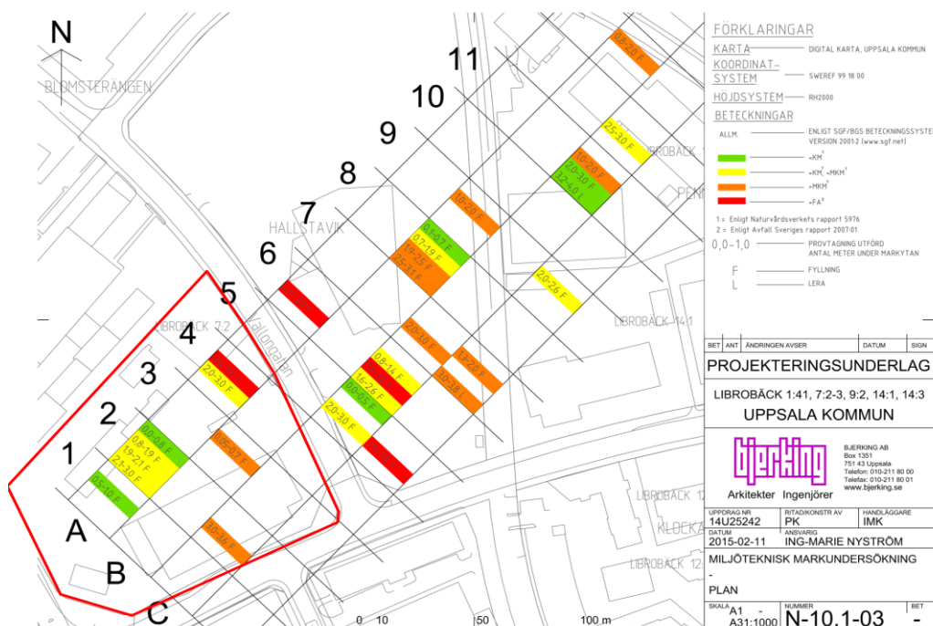
Figur 6. Uppmätta föroreningshalter i lertakten/deponin. Undersökningsområdet för denna miljötekniska undersökning är markerat med röd linje. De färgmarkerade nivåerna under markytan i rutorna betyder följande uppmätta föroreningshalter: Grön: < KM, Gul: KM-MKM, Orange: > MKM och Röd: > FA. Källa: Bjerkings undersökning 2015-02-11
