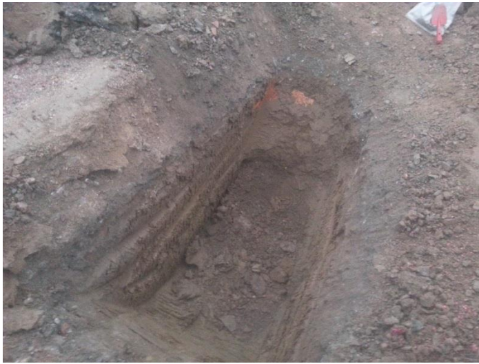
Figur 15. Provgrop i punkten LIB1505 där arsenik påträffades i det gråaktiga gruset.
