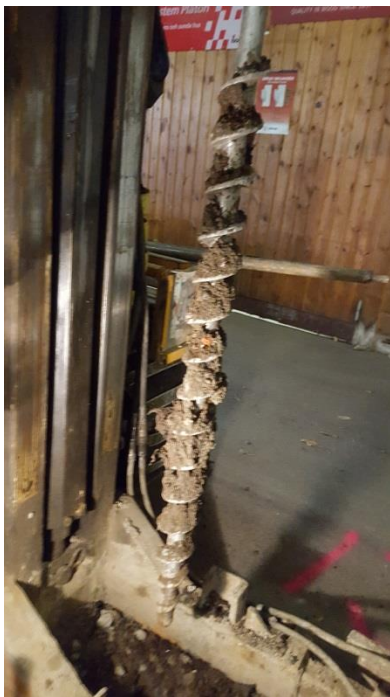
Figur 16. Jordprov på skruvborr i punkten LIB1513:5 till vänster samt jordprov på skruvborr i punkten LIB1515:8 till höger.
