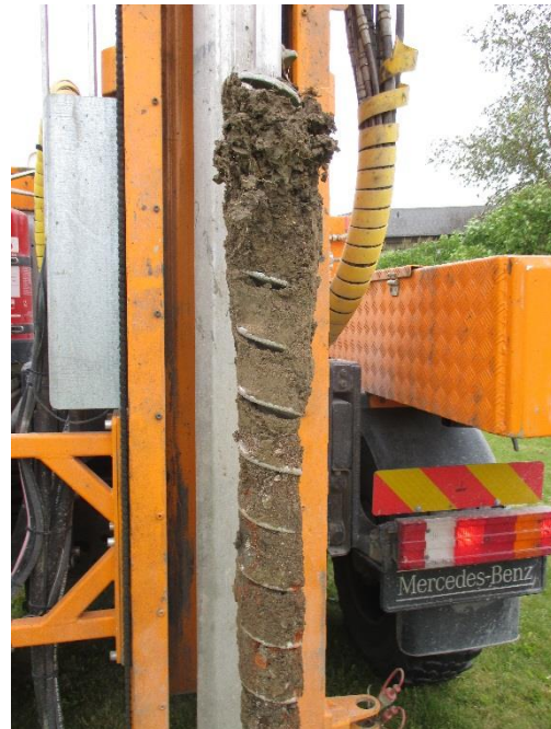
Bild 3B: 14BM04, 3,2-3,4 m Skruvprovtagning. Metallbitar i fyllningen som på detta djup luktade olja.
