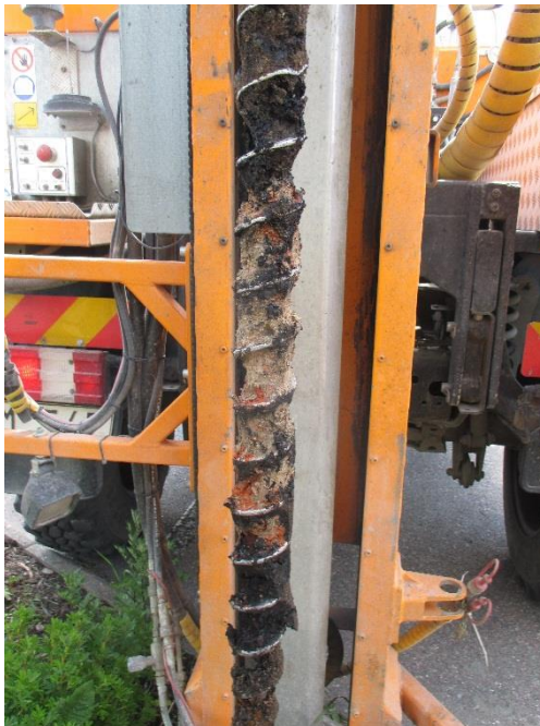
Bild 3A: 14BM04, 1-2 m Provtagning av sandig, lerig fyllning med inslag av tegel och svarta partier.
