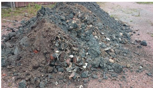
Bild 4A: Massor ur 14PG1 Från 0,8 till 1,8 m u my mörk lera. Lager med "sopmassor" mellan 1,8 och 2,0 m innehållande trä, metallbitar, glas, tegel mm
