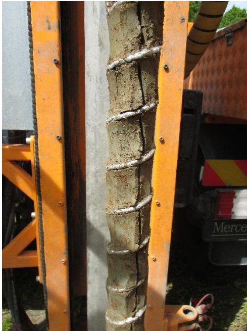
Bild 3E: 14BM16, 1-2 m Naturlig torrskorpelera med järnutfällningar. Provpunkten belägen utanför deponin.
