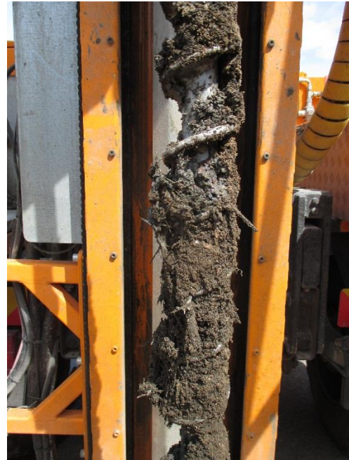
Bild 3F: 14BM17, 2-3 m Sandig, lerig fyllning med inslag av trä och med viss oljelukt.
