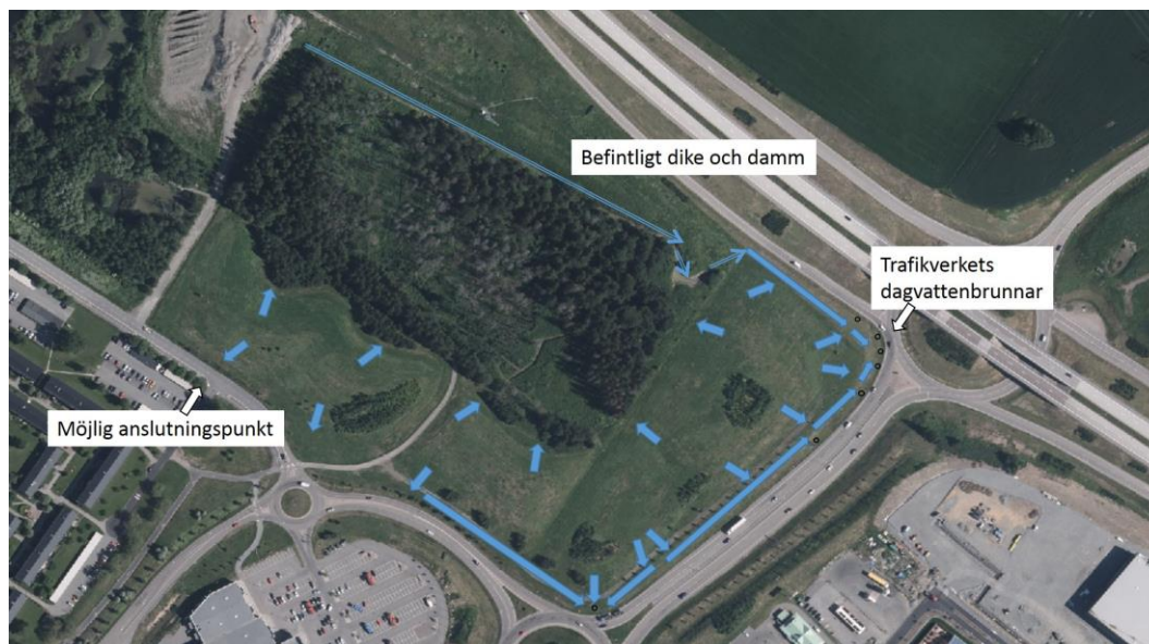
Figur 2. Principiell beskrivning av den befintliga avrinningen från området.
