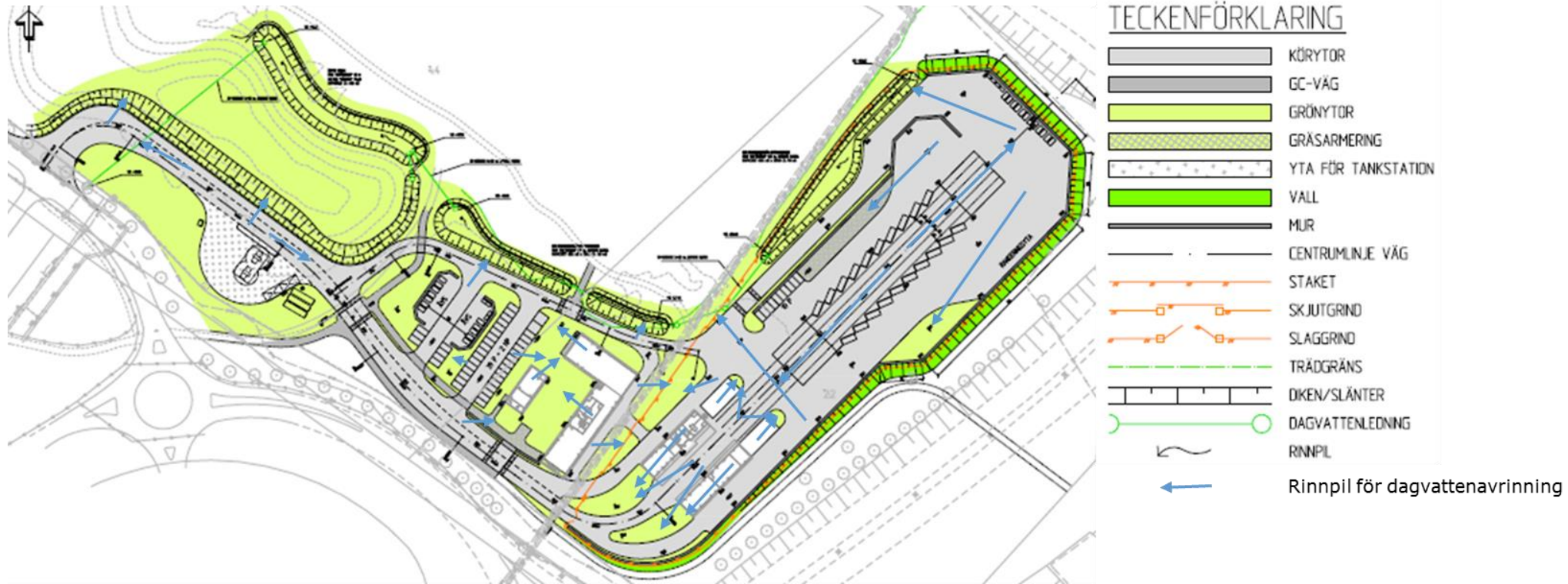
Figur 1. Principiell avrinning efter exploatering med införda dagvattenåtgärder. Avrinning sker mot grönytor och diken antingen via ytavrinning eller via brunn och ledning och möjliggörs genom anpassad höjdsättning. Avtappning från diken sker genom självfall mot avslitande damm vilken avtappas till det kommunala dagvattennätet. Underliggande illustration: Tyréns AB 20170512.
