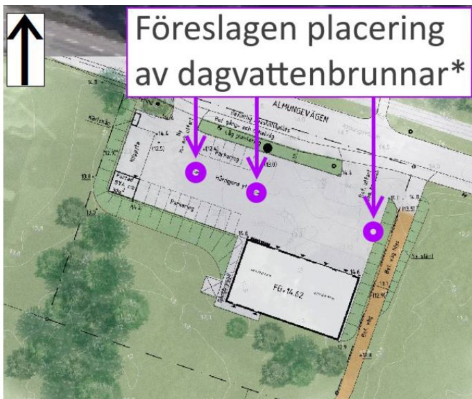
Utdrag ur dagvattenutredningen, som visar förslag på lägen för dagvattenbrunnar, som ska leda dagvattnet vidare till fördröjningsmagasinet, Sweco Architects AB.
