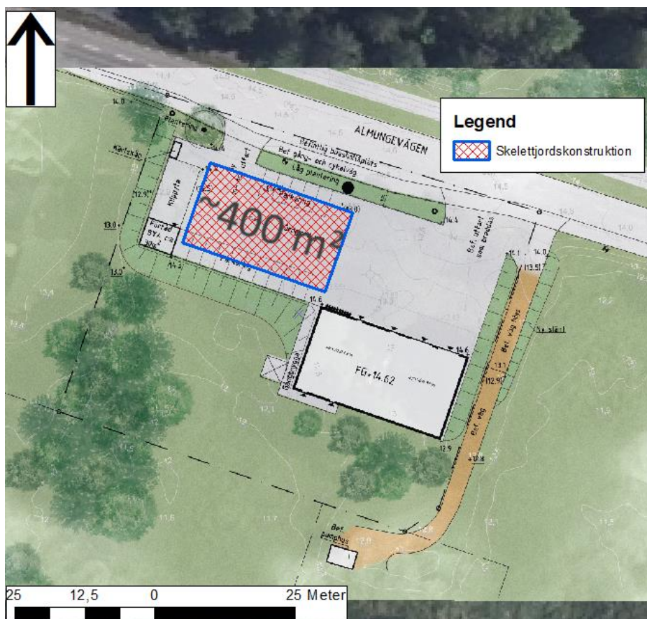
Figur 10. Figuren visar ett systemförslag för dagvattenhantering inom fastigheten. Det rekommenderas att så många ytor som möjligt görs permeabla, men den största födröjningen föreslås göras i en underjordisk skelettkonstruktion.
