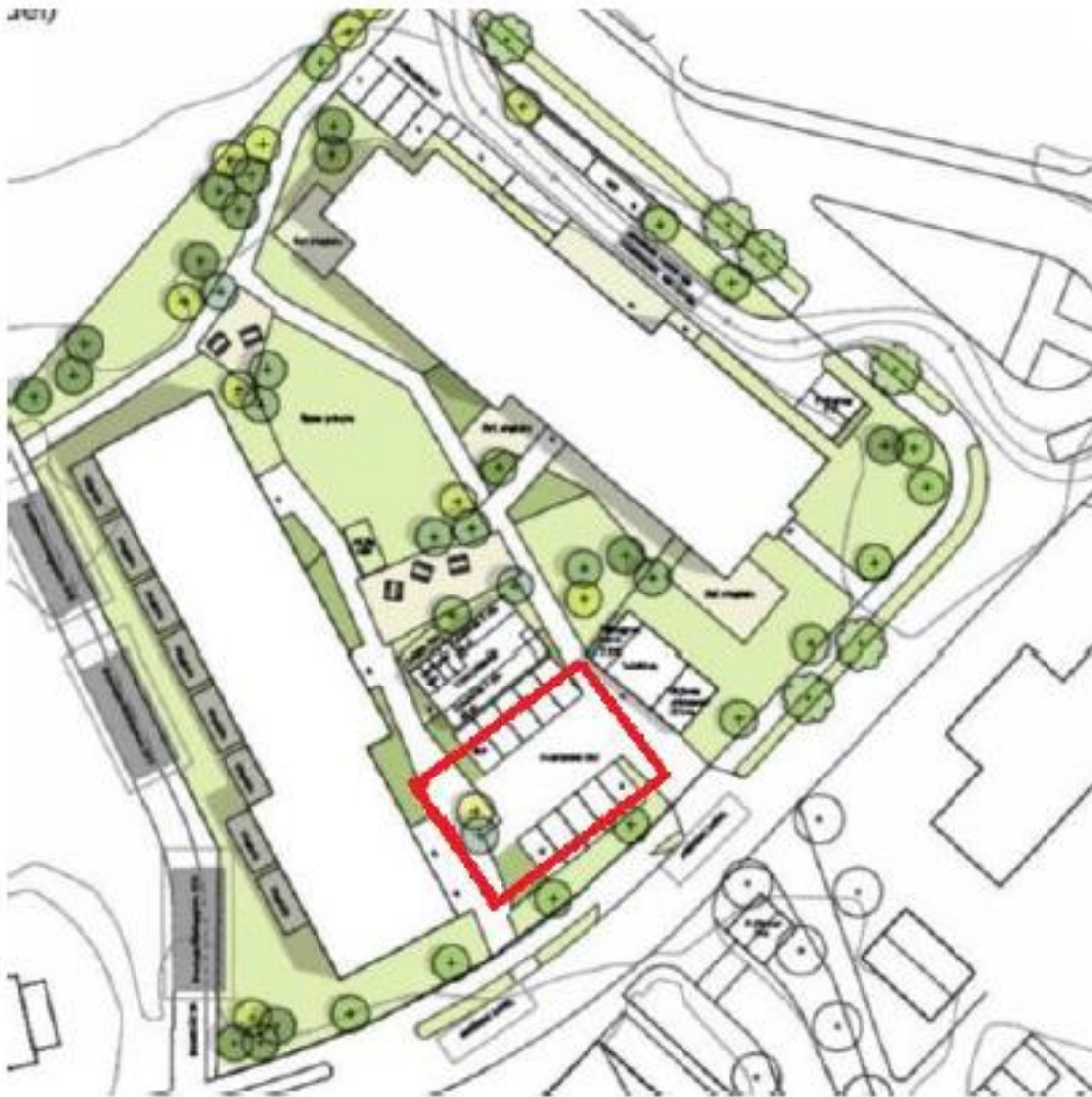
Figur 9. Den rödmarkerade rektangeln visar ett förslag på placering av ett makadammagasin med 1m mäktighet.
