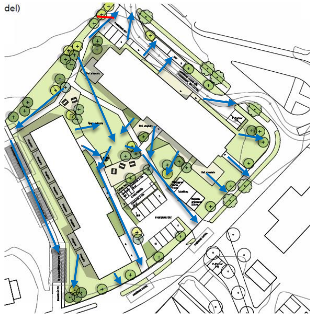
Figur 7. Blå pilar indikerar huvudsakliga avrinningsvägar vid skyfall efter planens genomförande. Röd markering visar ungefärligt läge för höjdpunkt. Illustrationsplan från Link Arkitektur 2020.
