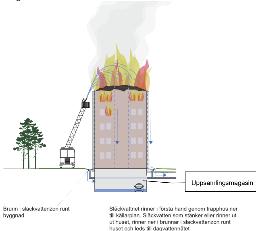
Figur 7. Illustration över hur släckvatten inom kvarter Ubbo kan omhändertas. Det underjordiska garaget fungerar som uppsamlingsmagasin för släckvattnet som hamnar i byggnaden. Tätskikt av geomembran HDPE-duk samt bentonitmatta (i släckvattenzon) ansluter till byggnad och säkerställer att släckvatten inte infiltrerar i marken. Genom att brunnar anläggs i släckvattenzonen runt byggnader samlas släckvatten upp och leds vidare till dagvattennätet.
