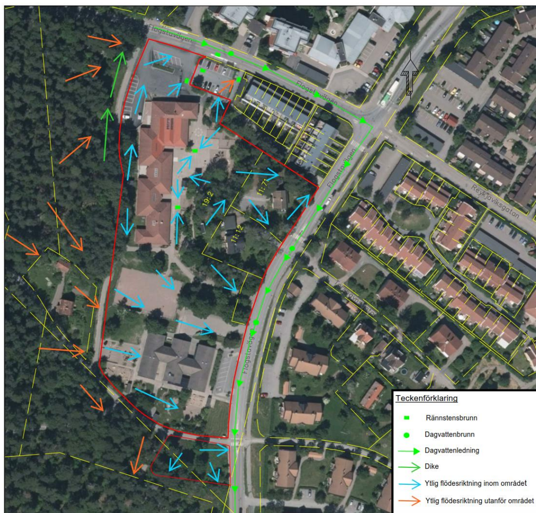
Figur 7a. Översiktlig beskrivning av yttlig avrinning inom utredningsområdet för befintlig situation. Ljusblå pilar indikerar generell flödesriktning för dagvatten inom utredningsområdet och orangea pilar avrinning utanför området. Teknisk avrinning utanför utredningsområdet visas med gröna pilar, ledningsnät i väg och ett dike väst om plangränserna.
