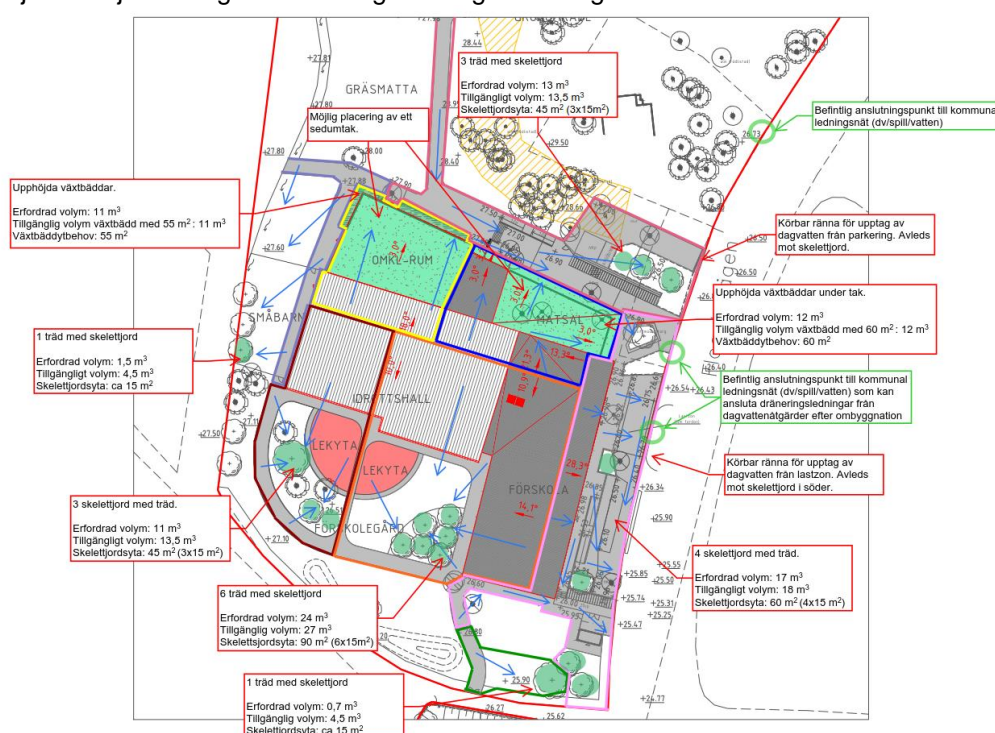
Figur 13. En översiktlig illustration över vart dagvattenåtgärder bör placeras vid Kullens förskola/Idrottshall/Mathall. Gråmarkerad yta visar hårdgjorda ytor. Lektyor visas i rött. Taket har röda pilar som visar lutningsgrad. Grönmarkerade ytor visar planerade dagvattenåtgärder. Andra områden i vitt kommer att bestå av gröna ytor som inte räknas med i dagvattenberäkningar.
