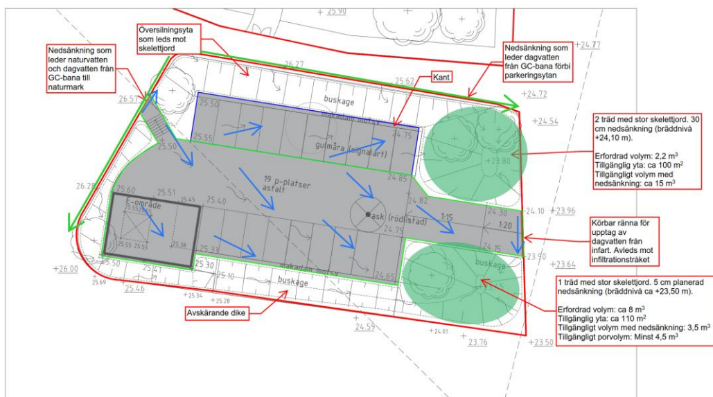
Figur 14. En översiktlig illustration över vart dagvattenåtgärderna bör placeras på parkeringsytan. Gråmarkerad yta visar hårdgjorda delar av parkeringsytan. Grönmarkerade ytor visar planerade dagvattenåtgärder. Andra områden i vitt kommer att bestå av gröna ytor som inte räknas med i dagvattenberäkningarna.
