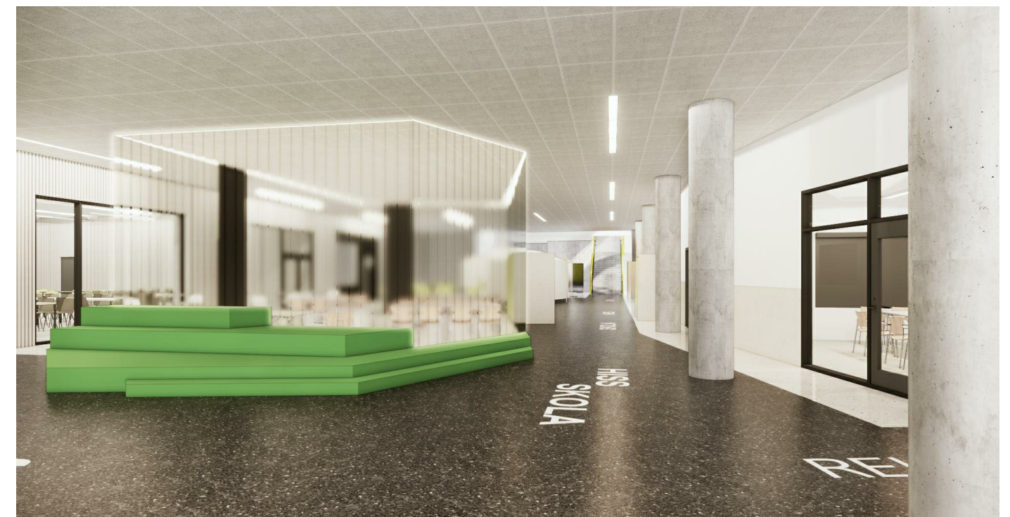
Entréhall, huvudstråk mot trappa och hiss. Grupprum Isberget, väggar av profilert typ Pilkinton glas, plywood på insidan (ev. två glas utan plywood). Bröstningspanel av plywood förlänger hållbarhet på korridorväggar. Pelare i naturbetong. Glasparti av stål.
