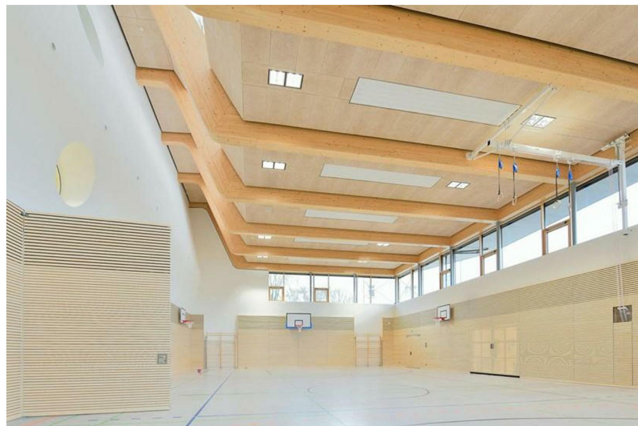
Ludwig Weber shule, idrottshall, träpanel och limträbalkar i taket
