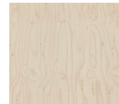
Väggspanel. Bröstningspanel av furuplywood, klarlack med vitpigment i kommunikation
