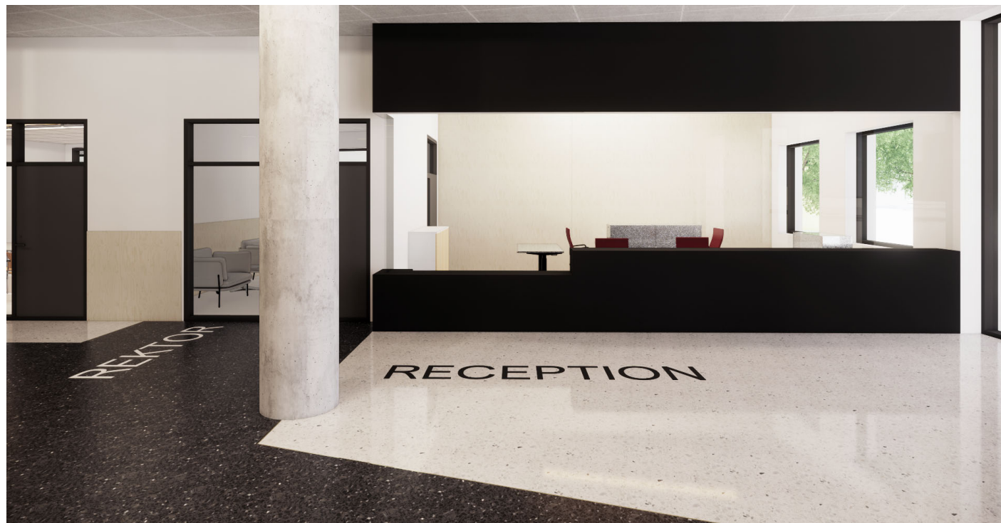
Receptionsdisk i direkt anslutning till huvudentré. Diskfront klädd med HT-laminat, två höjder. Stora öppningsbara glasfönster skyddar mot buller men tillåter personal ha bra uppsikt över alla som kommer in, bidrar till känslan av öppenhet och välkomnande.
