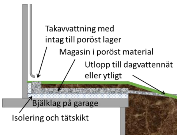
Figur 15. Principskiss på fördröjning av vatten på bjälklag.
