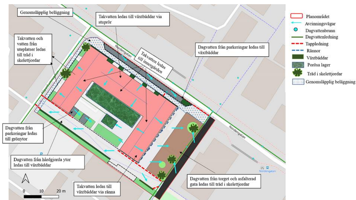
Figur 10. Schematisk skiss på hur dagvattenhanteringen kan lösas inom planområde med hjälp av växtbäddar, porösa lager på bjälklag, genomsläpplig beläggning och träd i skelettjordar. © Open Street Maps, bidragsgivare.
