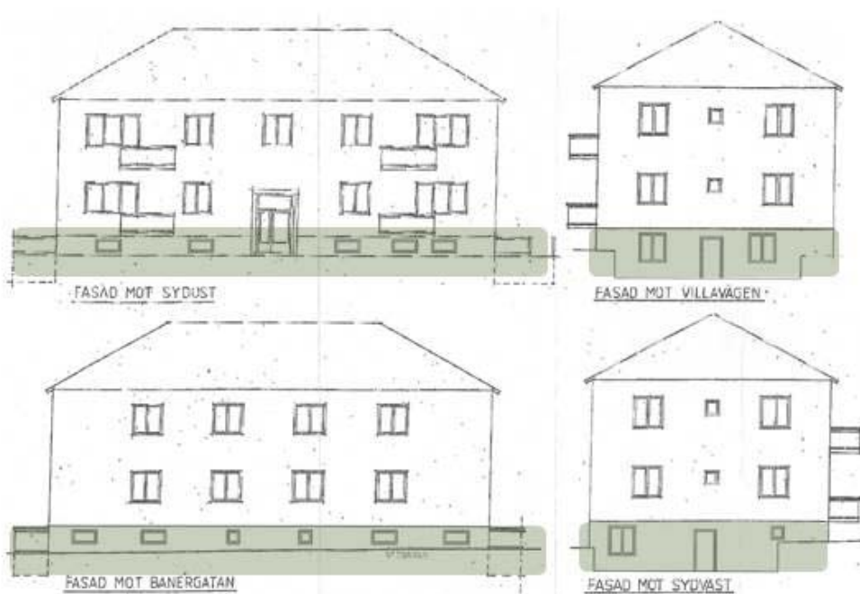
Illustration av den befintliga byggnaden efter ombyggnationen år 2008. Byggnaden har fått nya, större fönster i källarvåningen och två nya entréer vid byggnadens kortsidor.
