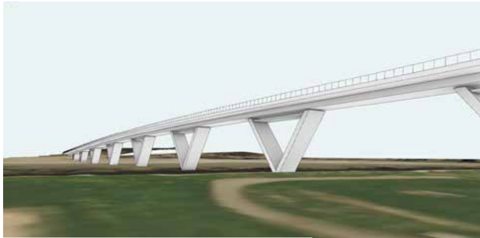
Exempel med V-formade stöd
