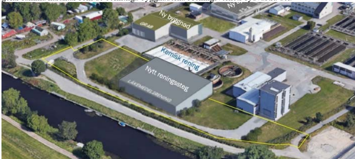
Volym studie som visar största tänkbara överbyggnad till det nya reningssteget. Utanför planområdet. Bakom det nya reningssteget och den befintliga kemiska reningen syns den planerade nya grovningen "Ny byggnad GRAB".
