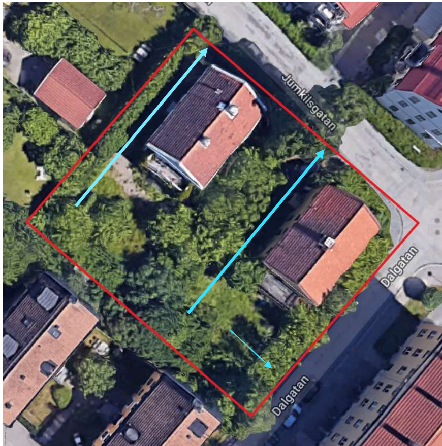
Figur 6. Översiktskarta med planområdet ungefärligt inringat i rött. Blå pilar visar nuvarande avvattningsvägar. De tjockare pilarna avser såväl ytavrinning vid skyfall, som avvattningsvägar via stuprör och dagvattenbrunnar till det kommunala dagvattennätet. Den tunnare pilen avser endast avrinning direkt från markytan till Dalgatan vid direktavrinning på markytan vid skyfall. Källa foto: Google (2019)
