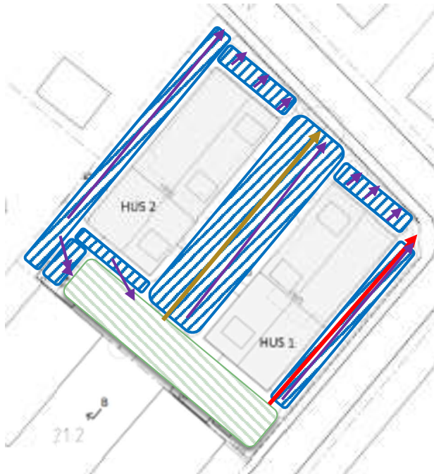
Figur 9. Principbild på möjliga placeringar av dagvattenförslag. Områden som kan anläggas med porösa jordar för hantering av takdagvatten och vatten från gångytor och grönytor är snedstreckade i blått. Områden som kan anläggas med porösa jordar med tät botten för hantering av dagvatten från körytor är snedstreckade i grönt. Lila pilar anger förslag på huvudsakliga flödesriktningar. Röd pil anger flödesväg för dagvattenledning från magasin för dagvatten från körytor, med gul pil för alternativ placering.
