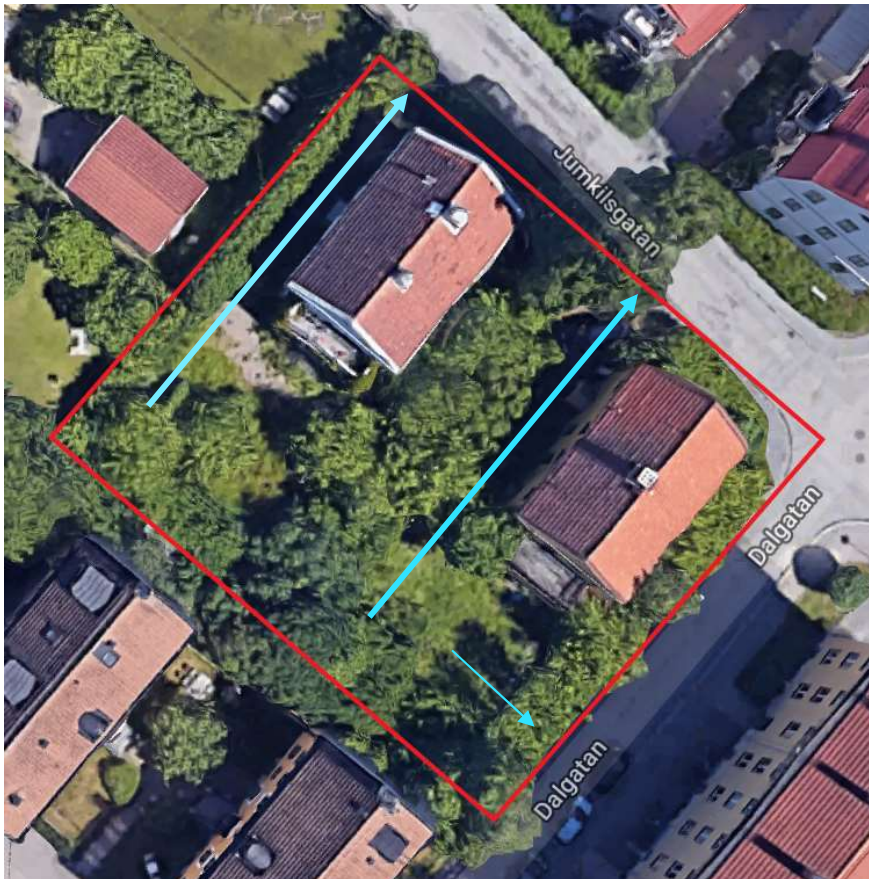
Figur 6. Översiktskarta med planområdet ungefärligt inringat i rött. Blå pilar visar nuvarande avvattningsvägar. De tjockare pilarna avser såväl ytavrinning vid skyfall, som avvattningsvägar via stuprör och dagvattenbrunnar till det kommunala dagvattennätet. Den tunnare pilen avser endast avvattningsvägar direkt från markytan till Dalgatan vid direktavrinning på markytan vid skyfall. Källa foto: Google (2019)
