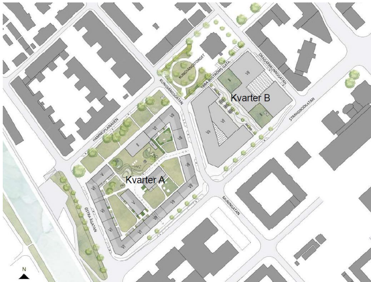
Illustrationsplan över planförslagets struktur med indelning i två kvarter och en ny sydlig fortsättning av Kungsängsgatan som kopplar vidare mot Muningsgatan i Kungsängen, Alma arkitekter.
