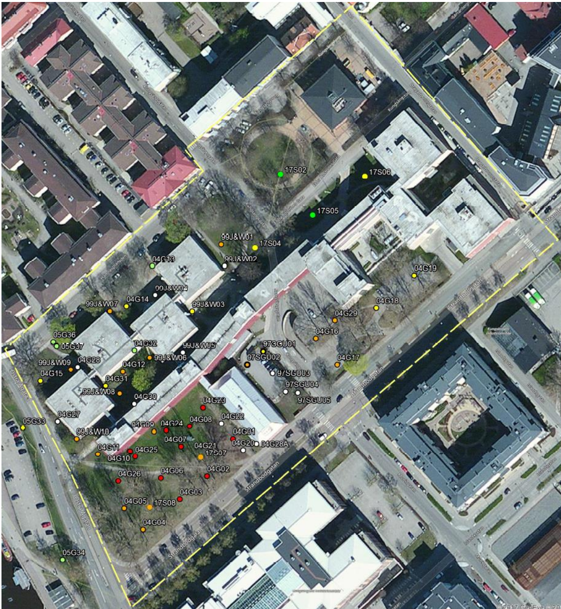
Figur 2. Provtagningspunkter inom kvarter Hugin. Grönt indikerar maxhalt under RV_{KM} , gult maxhalt under RV_{MKM} , orange maxhalt över RV_{MKM} , och rött halt över gräns för farligt avfall.
