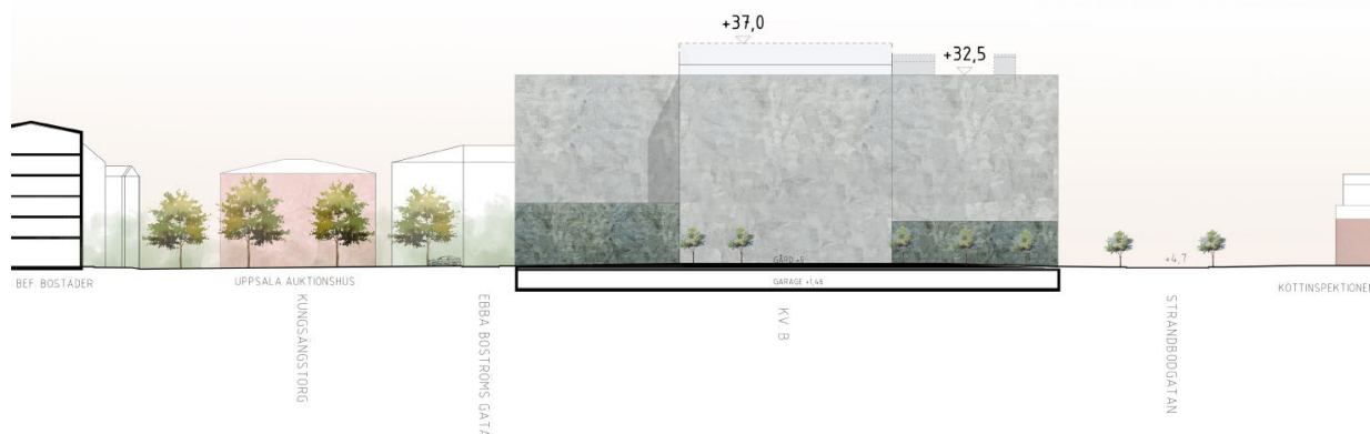
Sektion, sett västerifrån, som visar höjdförhållandena i planförslaget i jämförelse med befintliga byggnader inklusive Uppsala auktionskammare och Köttinspektionen. För Köttinspektionen är det den lägre delen, som visas i grönt, som ligger tvärs över gatan från denna, medan Uppsala auktionskammaren ligger mittemellan de lägre och högre byggnadsdelarna. Bild: Alma arkitekter. Plushöjderna är anges i meter ovan nollplanet.
